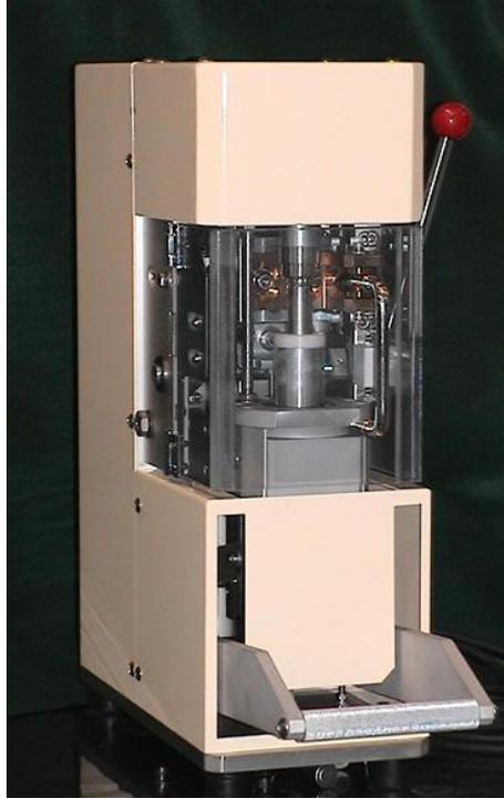
電池缶とキャップの封口前の、缶への溝入れを行う装置です。
