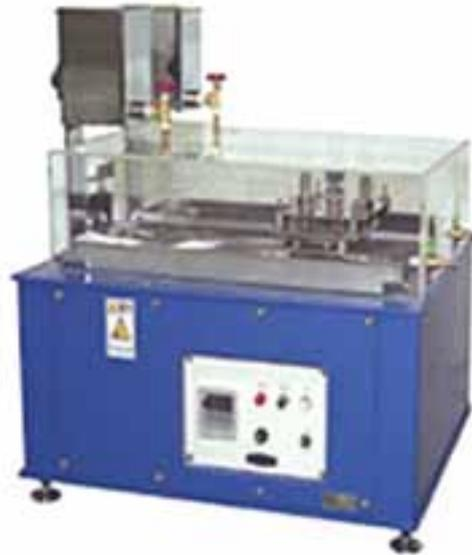
床材、塗装・印刷面の耐洗浄摩耗特性を測定する装置です。ブラケットには試料によりスポンジボックス・ブラシボックス等を取付けて試験します。
